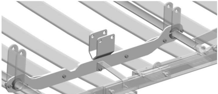
Acto seguido, fije el accionamiento más corto para el soporte para los pies con un perno y un clip de seguridad tanto en el alojamiento del motor como en la lengüeta. El accionamiento más largo para del soporte del cabecero se fija en el alojamiento del motor con un perno y el clip de seguridad correspondiente, así como en la lengüeta con el pasador de clavija para el descenso de emergencia.
