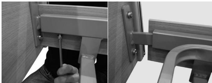
A continuación, suspenda las protecciones laterales en las guías de metal premontadas y céntrelas. **TENGA EN CUENTA** siempre la rotulación que aparece en las partes superior e inferior de las tapas de las protecciones laterales, pues estas no pueden intercambiarse.
