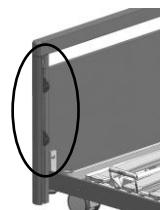
Svitare la vite nella parte inferiore della guida a C, rimuovere il raccordo verso il basso e reinserire la vite.
