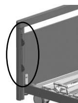
Desserrez la vis en bas de la glissière, retirez les fourches d'appui en les tirant vers le bas et remettez la vis en place.
