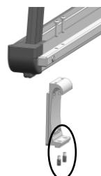
Adesso, montare con le viti a testa cilindrica il sostegno sulla sponda SR1.
