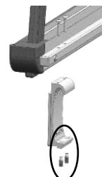
Als nächsten Schritt mit den Linsenkopf- schrauben den Halter an die Seitensiche- rung SR1 montieren.
