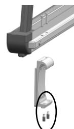
De volgende stap is om met behulp van de ovaalkopschroeven de houder aan de zijhekken SR1 te monteren.
