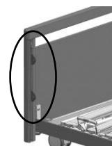
Draai de schroef aan de onderkant van de C-rail los, verwijder de fitting er van onderen uit en zet de schroefverbinding er weer in.
