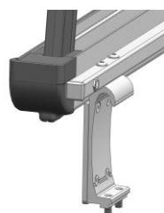
*Esempio lato testa lungo – Montaggio della sponda SR1*
