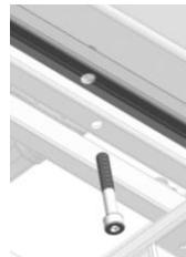
Atornille los dos tornillos cilíndricos M8x55 en la tuerca de racor M8 introduciéndolos desde abajo a través del armazón de acero.
