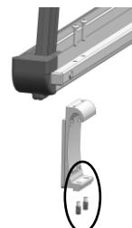
Ensuite, montez le support sur la barrière latérale SR1 en utilisant des vis à tête bombée.
