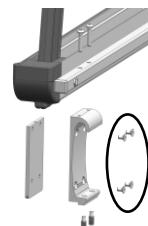
De volgende stap is om de stelschroeven lichtjes in de aluminiumhouder te draaien.
