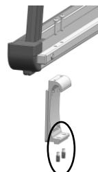
En el siguiente paso, utilice los tornillos alomados para montar el soporte en la protección lateral SR1.
